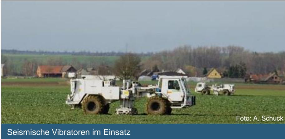
Seismische Vibratoren im Einsatz
